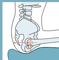
Der VAS mit Ergo-Joint bietet eine manuelle oder elektrische -5 bis +30° Rückenwinkelverstellung ohne Scherkräfte, bei optimaler Anpassung der Sitzpolsterung.
